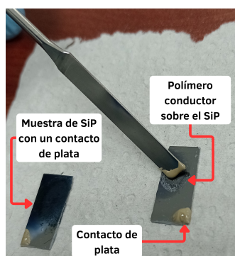
(a) Colocación de los puntos de plata en una muestra.
