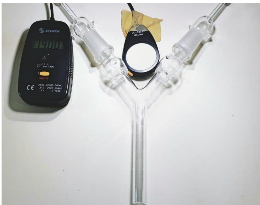
Figura 6. Olfatómetro de dos vías para evaluar la respuesta de hembras y machos de Macroductylus nigripes hacia compuestos volátiles considerados en el presente estudio. Luxómetro utilizado para medir la iluminación en el laboratorio de bioensayos.
