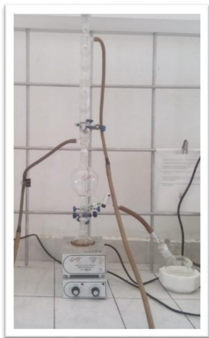
Figura 2.3 Sistema de destilación para la purificación del metanol.
