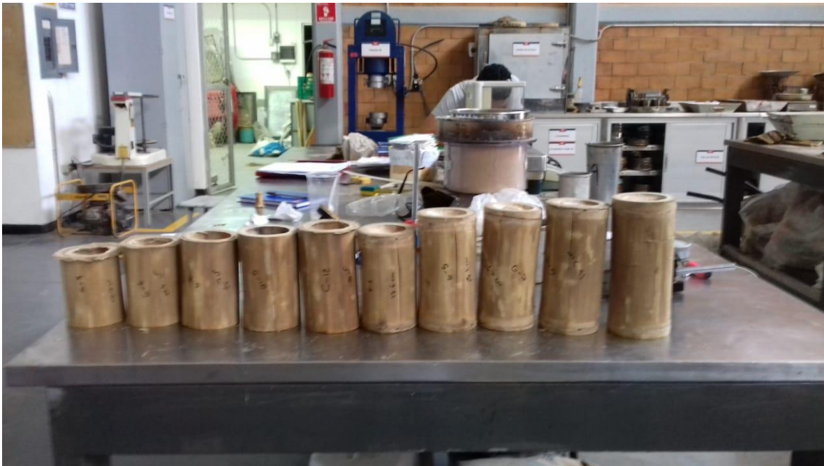
Figura 3.7. Probetas de Guadua angustifolia después de realizarse la prueba de compresión.
