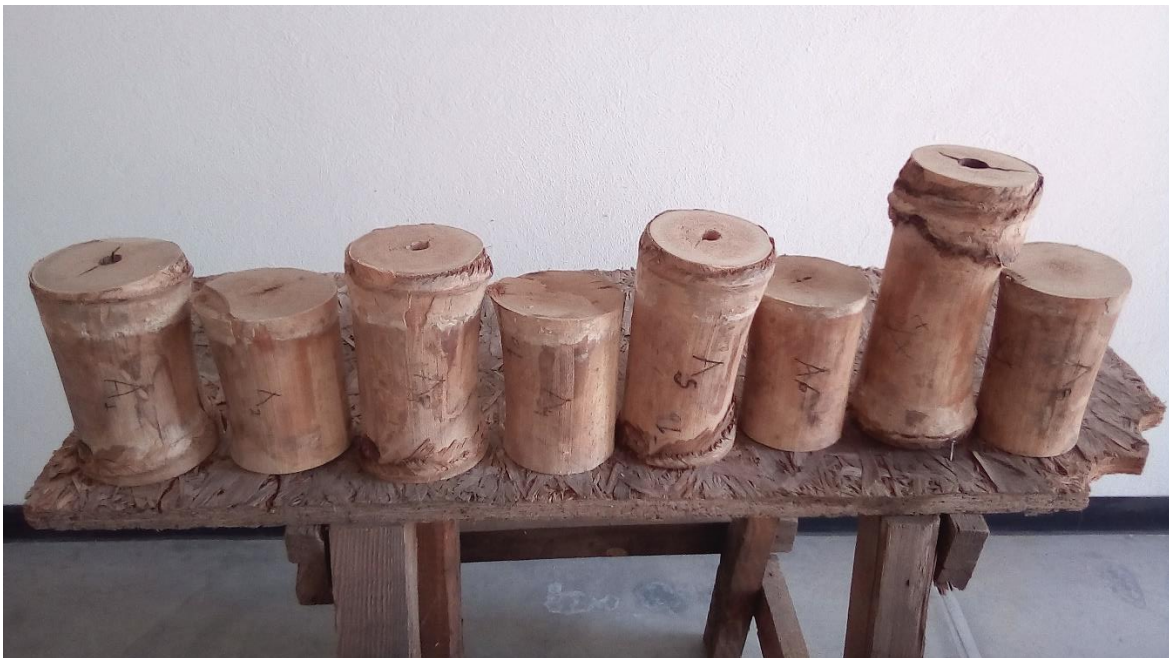
Figura 3.32. Probetas de Ocotate para las pruebas de compresión.
