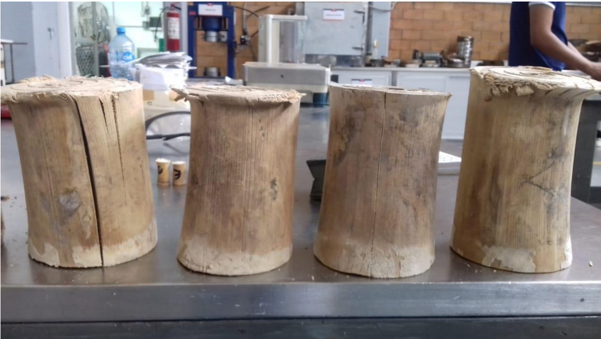
Figura 3.34. Probetas de Ocotate sin nudo después de la compresión.
