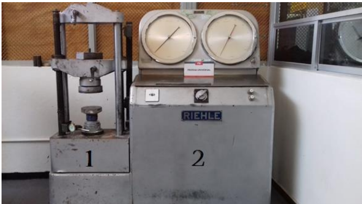
Fig. 2.2. Máquina universal. 1) sección de pruebas, 2) sección de control.
