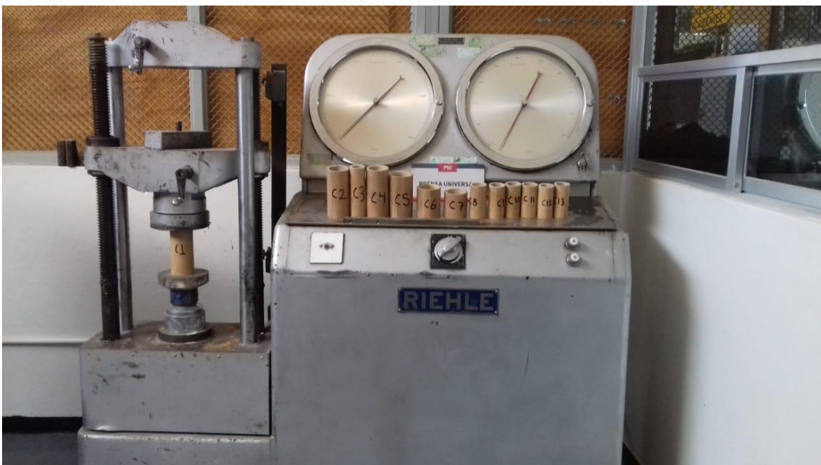
Figura 3.16. Probetas para las pruebas de compresión. Especie Bambusa oldhamii .
