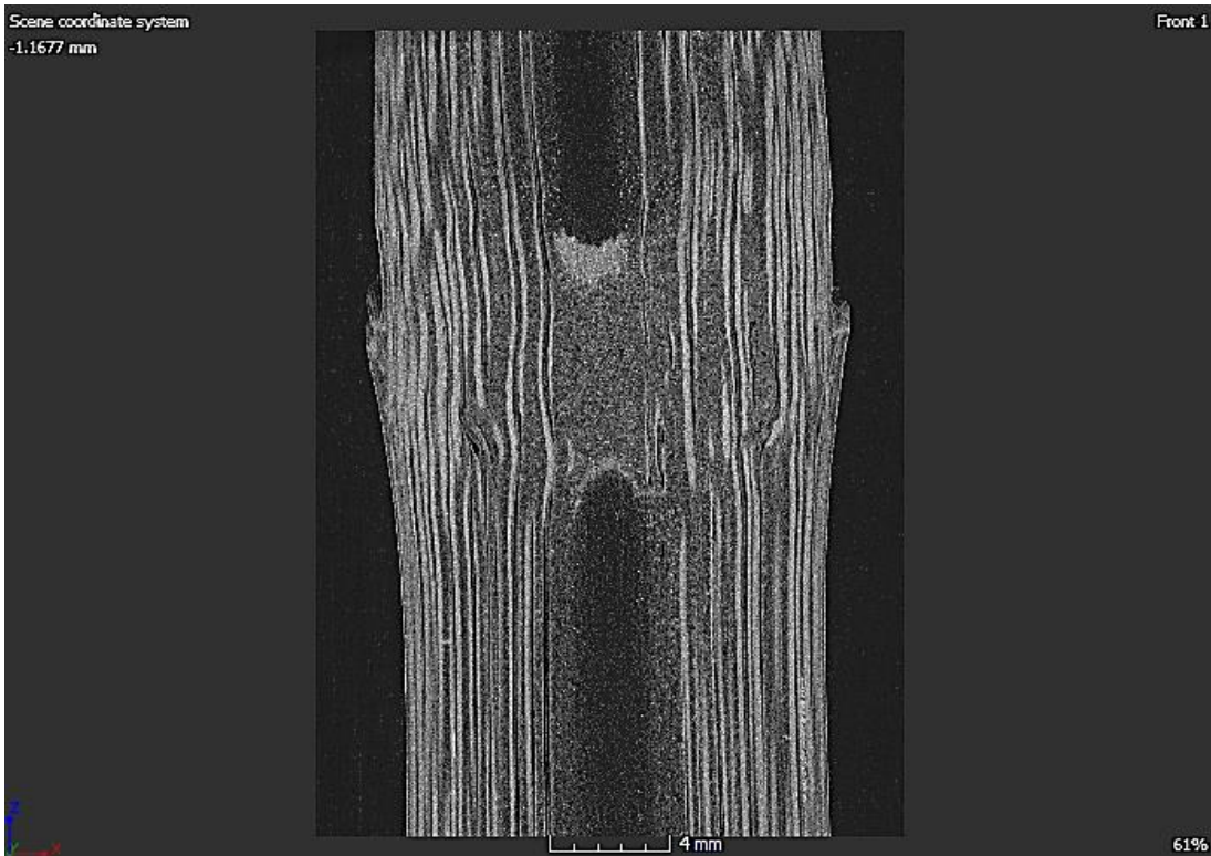
Figura 4.3. Corte transversal del culmo del bambú en el nudo.
