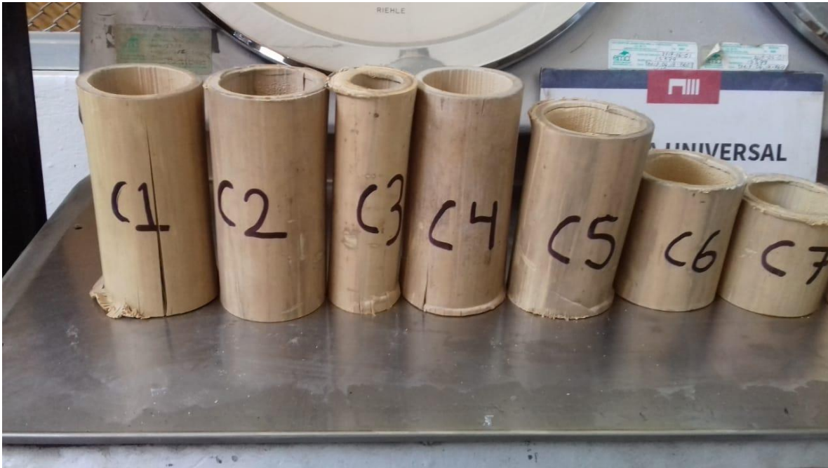
Figura 3.17. Probetas 1-7 después de realizar la compresión. Especie Bambusa oldhamii.
