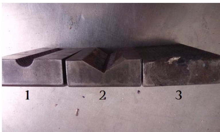
Figura 2.3. Placas para mordazas tipo: 1) media caña, 2) triangular, y 3) plana.
