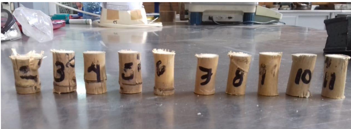
Figura 3.24. Probetas de la especie Otatea acuminata , después de la prueba de compresión.
