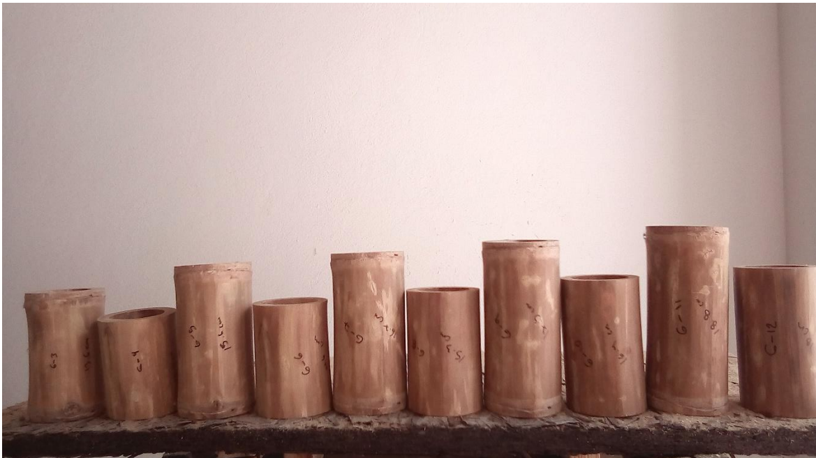
Figura 3.6. Probetas de la especie Guadua angustifolia para realizar pruebas de compresión con nudo y sin nudo.
