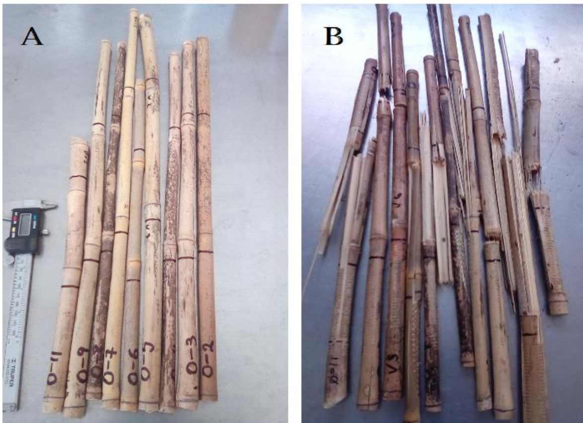
Figura 3.21. Probetas de la especie Otatea acuminata . A) antes de la prueba de tensión, B) después de la prueba de tensión.
