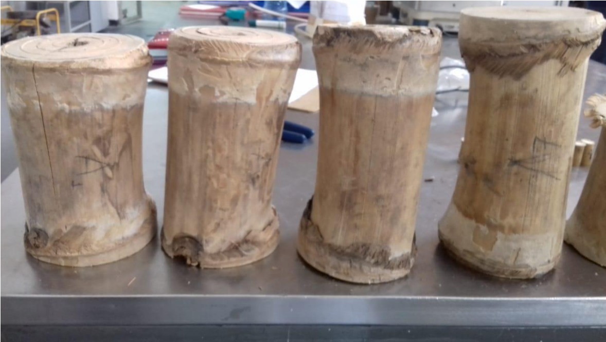
Figura 3.33. Probetas de Ocotate con nudo después de la compresión.
