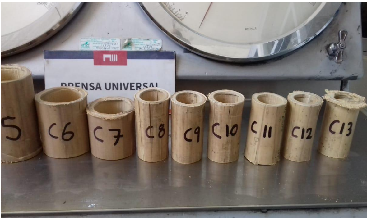
Fig. 3.18. Probetas 5-13 después de realizar la compresión. Especie Bambusa oldhamii.
