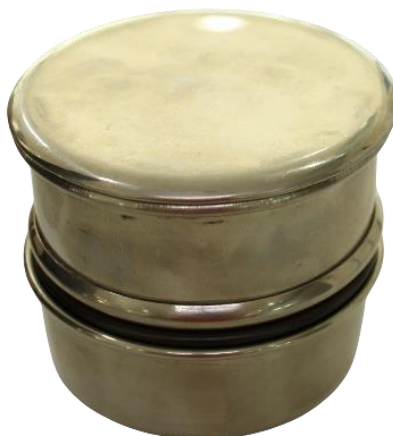
Figura 7 Tamiz No. 325 cerrado para el método físico de agitación.
