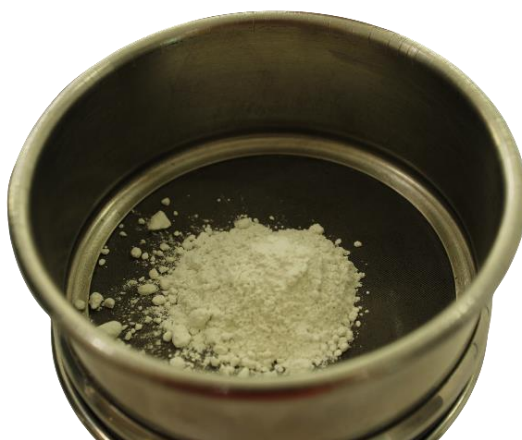
Figura 8 Cemento sinterizado en tamiz.
