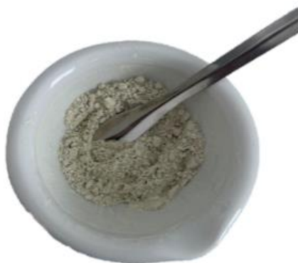
Figura 10 Imagen de cemento experimental y SrO homogeneizado.
