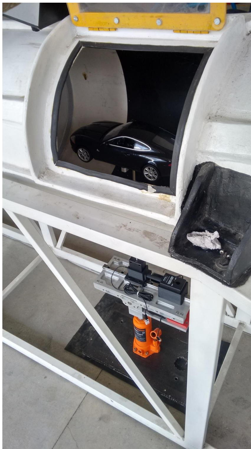
Fig. 5.2 Modelo Jaguar XKR sobre la balanza de fuerzas.
