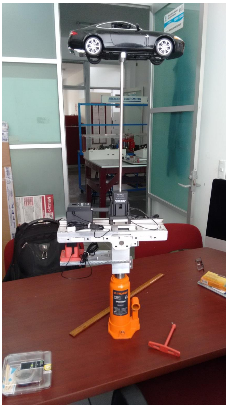
Fig. 4.17 Balanza de fuerzas terminada.
