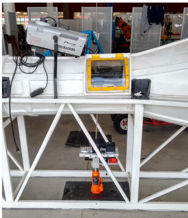
Fig. 5.1 Balanza de fuerzas colocada debajo de la cámara de prueba.
