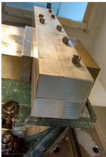
Fig. 4.10 Montado del stock en el centro de maquinado.
