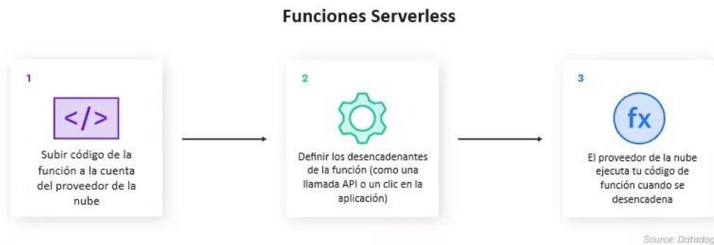
Figura 2-6 Funcionamiento de arquitectura Serverless, recuperado y traducido de [37]
