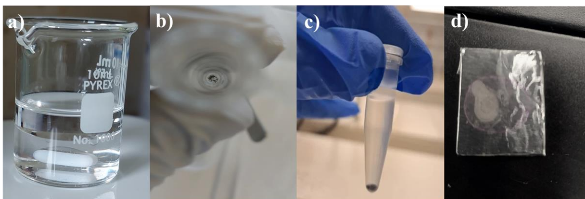
Fig. 17 a) Mezcla de hexano y acetato de etilo, b) Precipitación de las nanopartículas de plata, c) Espejo de plata ya formado y d) Espejo de plata recuperado y colocado en borosilicato recubierto con aluminio.
