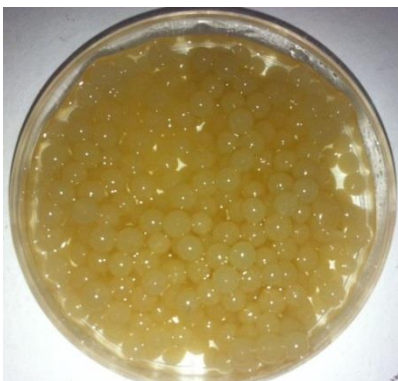
Figura 2.1. Pellets que contienen compósito SBA-15/Montmorillonita al 25%.
