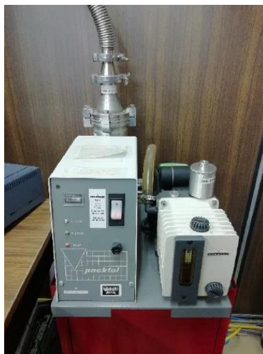
Figura 3.8. Bomba mecánica Alcatel V7360 conectada en serie con una bomba de arrastre molecular Alcatel MDP5011.
