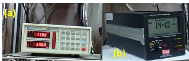
Figura 3.7. (a) Controlador digital de temperatura LakeShore 330. (b) Diodo digital de presión.
