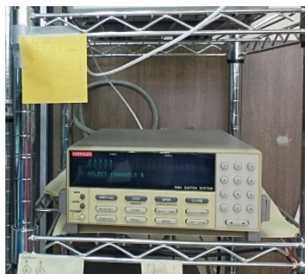
Figura 3.5. Sistema de conmutación Keithley 7001 con una tarjeta Hall 706.
