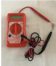
Figura 2.1. Multímetro convencional. Ejemplo de la Técnica de Dos Puntas [14].
