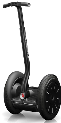
Figura 3. Segway: vehículo de transporte. Ejemplo de un sistema símil al péndulo invertido.
