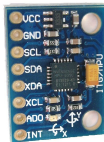
Figura 2.7. Sistema Microelectromecánico MPU6050 con acelerómetro y giróscopo integrado.
