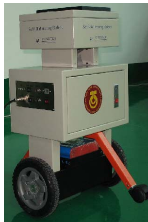
Figura 1.2. Robot péndulo invertido sobre dos ruedas: T-WIP. Desarrollado en la Universidad Tecnológica de Malasia.
