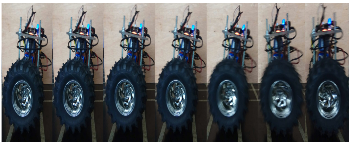
Figura 3.19. Secuencia de imágenes del prototipo péndulo invertido funcionando con el controlador PID.
