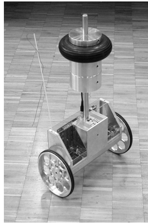
Figura 1.1. Péndulo invertido móvil: JOE. Desarrollado en Swiss Federal Institute Technology Lausanne (EPFL).
