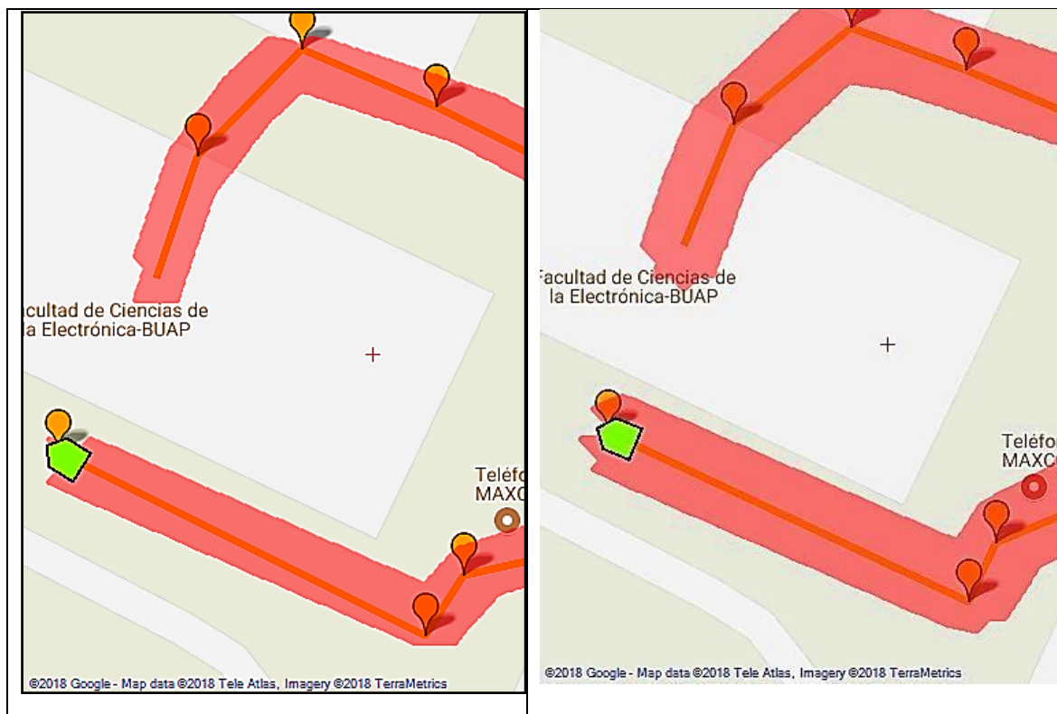
Figura 15. Ruta del vehículo aplicando las tolerancias de los GPS comerciales. A la izquierda es una tolerancia de \pm 1 \text{ m} , a la derecha una tolerancia de \pm 2 \text{ m}
