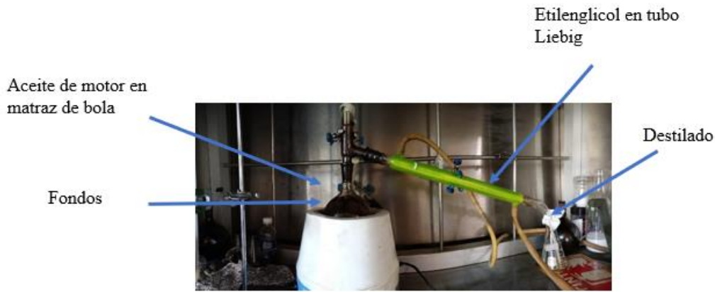
Figura 2.2 Sistema de destilación simple
