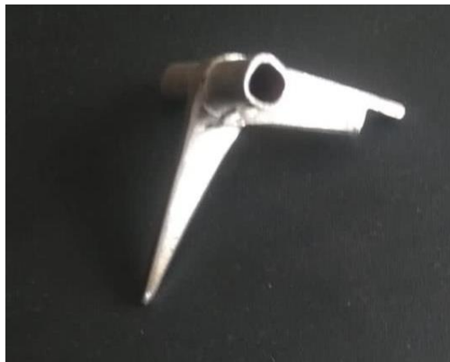
Imagen 6. Palanca de desplazamiento para la guillotina. Foto del autor.
