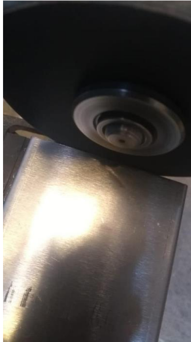
Imagen 2. Corte con Mini pulidor del molde del consistómetro. Foto del autor.
