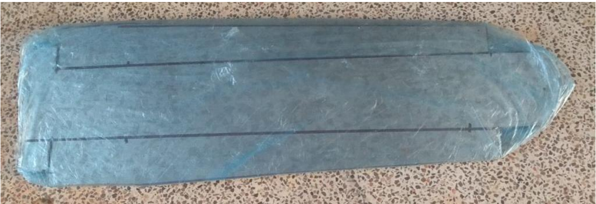
Imagen 1. Trazo del consistómetro en la placa de acero inoxidable, grado alimenticio. Foto del autor.
