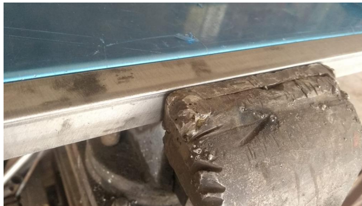
Imagen 3. Dobles a 90° de la placa del consistómetro. Foto del autor.
