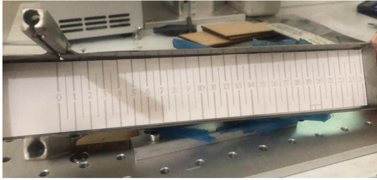
Imagen 9. Graduación marcada con láser. Foto del autor.
