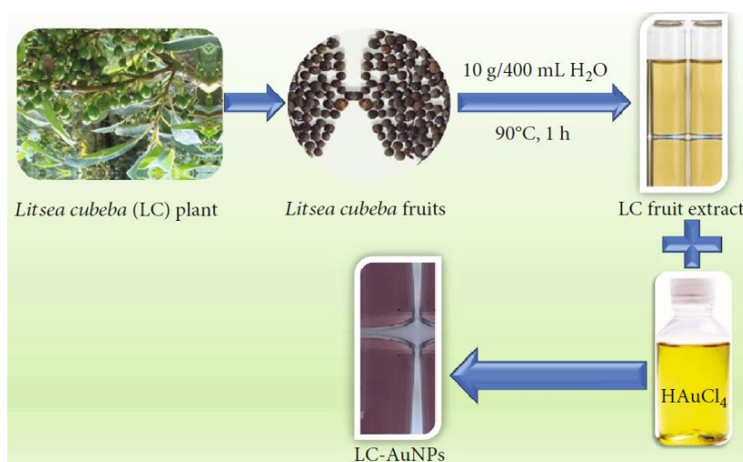
Figura 1.4. Procedimiento de síntesis de AuNP utilizando extracto de fruta de Litsea cubeba .
