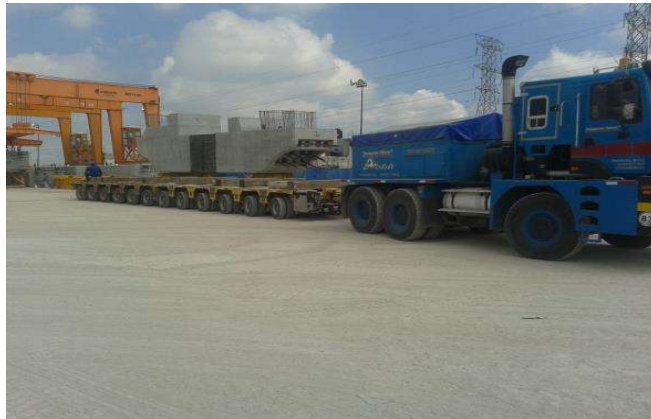
Fotografía 32. Estiba y colocación de elemento en plataforma
