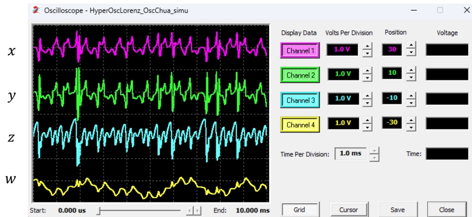
Figura 4.11. Simulación del sistema hipercaótico de Lorenz en AnadigmDesigner2 para las variables (a)x, (b) y (c) z (d) w.
