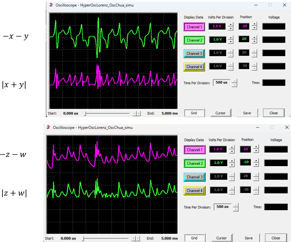
Figura 4.13. Simulación del sistema hipercaótico de Lorenz en AnadigmDesigner2 con etapa de operaciones.
