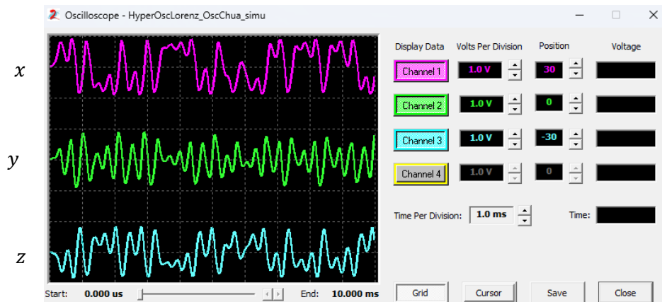
Figura 4.9. Simulación del sistema caótico de Chua en AnadigmDesigner2 para las variables (a)x, (b) y (c) z.
