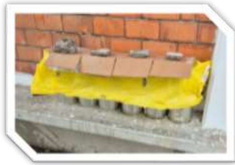
Ilustración 16. Probetas para pruebas de compresión ASTM C39
