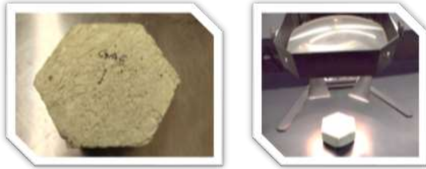
Ilustración 56. Evaluación visual del adoquín después de los impactos de la caída de bola
