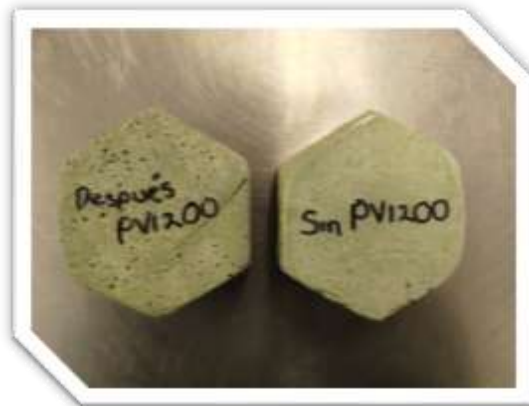
Ilustración 55. Foto comparativa entre 2 adoquines después de cámara PV1200
