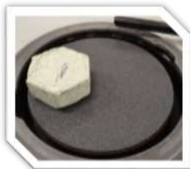
Ilustración 32. Ensayo de abrasión por fricción seca
