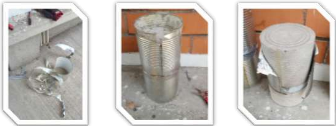
Ilustración 18. Desmolde y preparación de probetas
