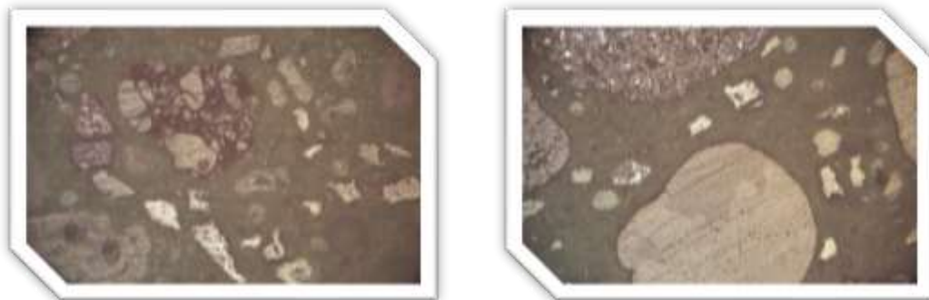
Ilustración 58. Microestructura de la matriz polímero/solvente-cemento en un aumento x5
