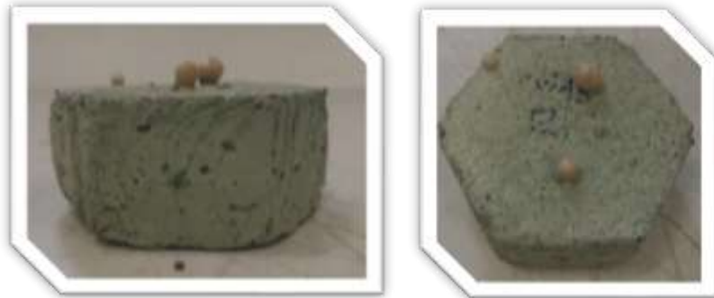
Ilustración 51. Presencia de burbujas en el adoquín después de 4 días de prueba en cámara de cambios climáticos
