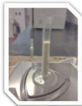
Ilustración 6. Muestra de polvo de poliestireno Ilustración 7. Determinación de la densidad aparente para el polvo de poliestireno
