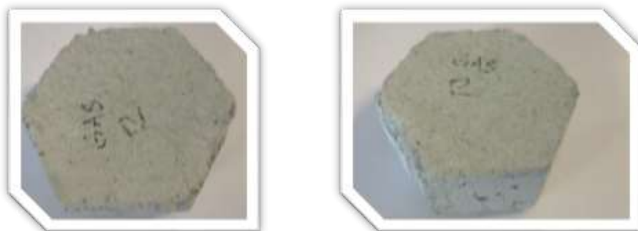
Ilustración 50. Adoquines para prueba en cámara de cambios climáticos
