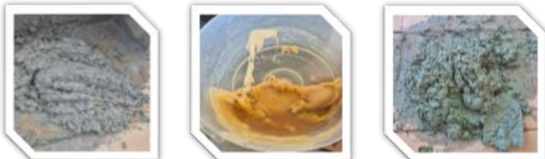
Ilustración 25. Preparación del mortero, la disolución del polvo de poliestireno en gasolina y la incorporación del agregado extra y el aditivo
