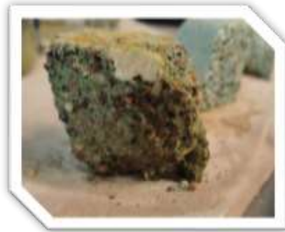
Ilustración 63. Muestra deteriorada por HCl
