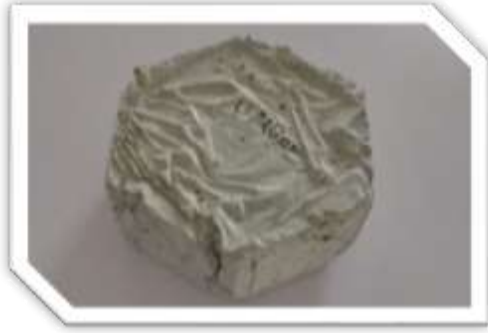
Ilustración 27. Adoquín para prueba de absorción de agua
