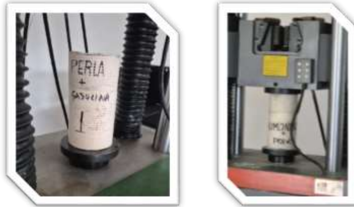
Ilustración 21. Pruebas de compresión ASTM C39
