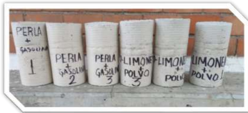
Ilustración 36. Identificación de probetas para prueba ASTM C39
