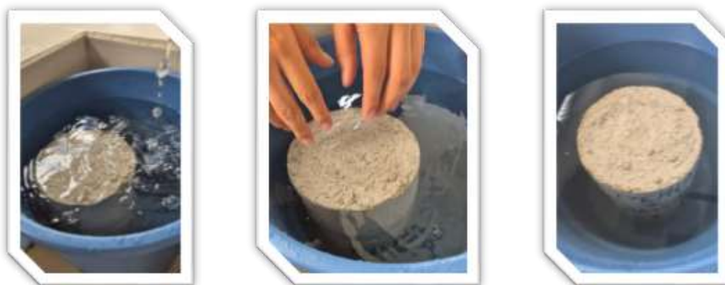
Ilustración 20. Aseguramiento de condiciones de humedad controlada
