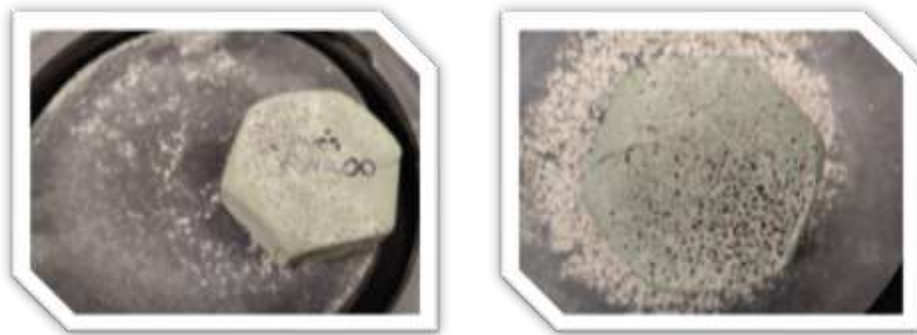
Ilustración 57. Adoquín después de 500 ciclos de lijado
