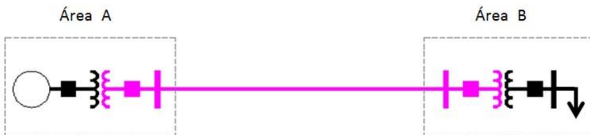
Figura 2.1 Sistema de potencia radial
