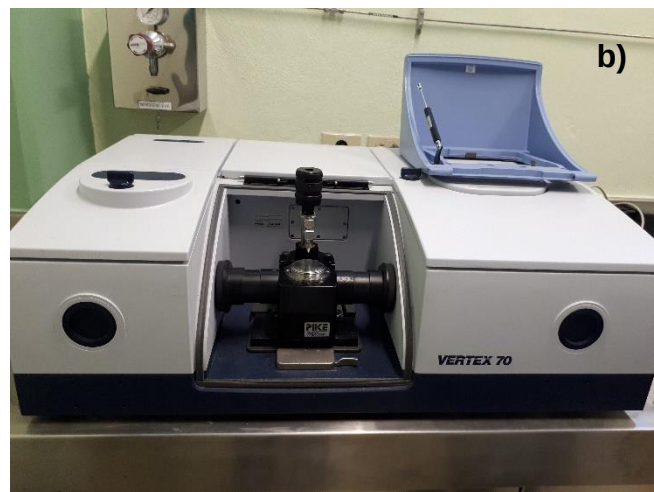
Fig. 5. a) Laboratorio para FT-IR, TGA/DSC DITCo. b) Espectrómetro Bruker Vertex 70. Fuente propia.
