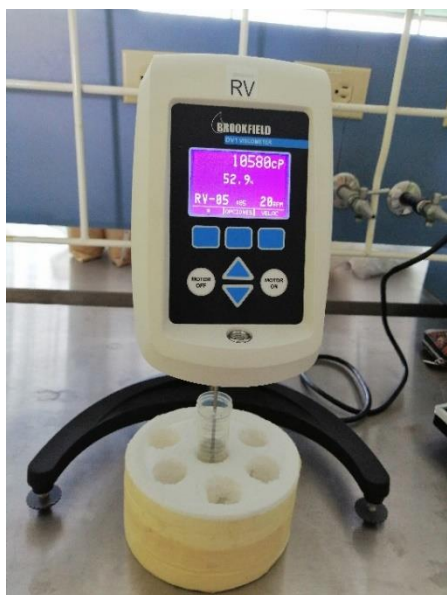
Fig. 11. Viscosímetro realizando la medición con la punta RV-05 a 20 RPM. Fuente propia.
