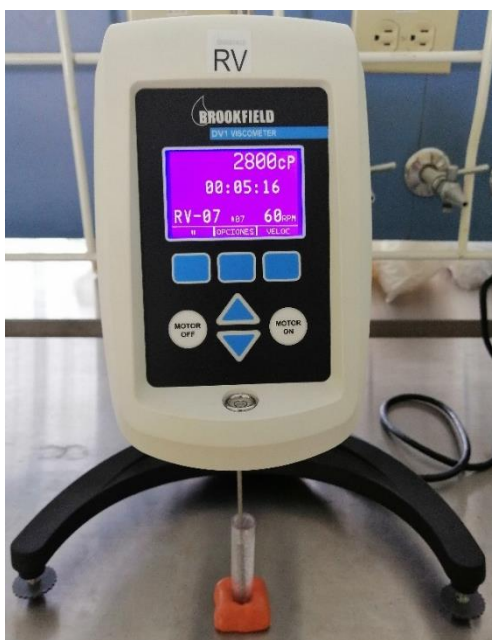
Fig. 10. Viscosímetro realizando medición de viscosidad punta RV-07 60 RPM. Fuente propia.
