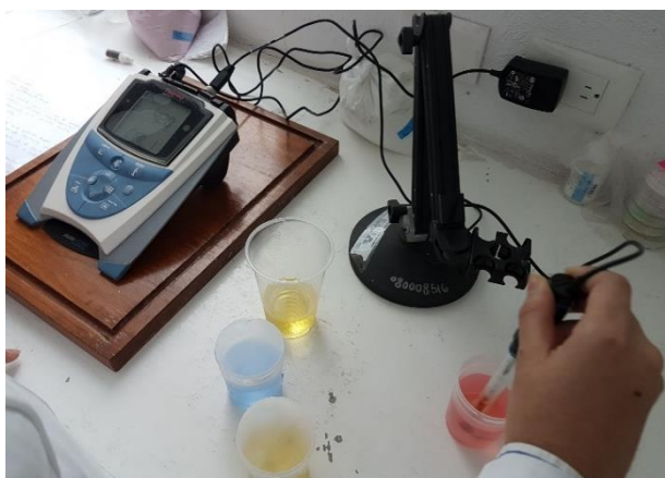
Fig. 1. Potenciómetro del laboratorio de materiales. a) Calibración previa para tomar pH. b) Medición del pH de la solución de metformina. Fuente propia.
