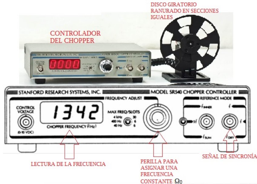
Figura B.9: Disco giratorio ranurado en secciones iguales con su controlador.
