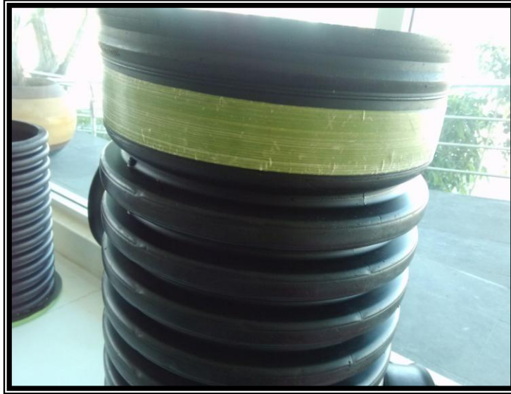
Figura 2.4 la banda verde de cerámica es el elemento que da rigidez y funciona como un cinturón
