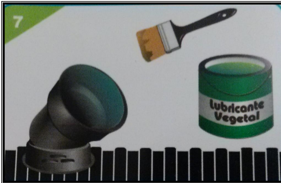
Figura 3.6.7 Lubricación de campana
