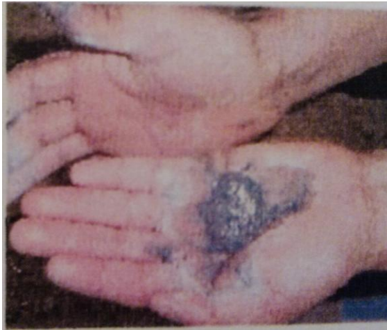
Figura 2.3.7 Con esta prueba se estima la rapidez con que la superficie toma una apariencia lustrosa.
