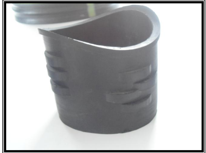
Figura 3.4.6. Empaque elastomérico de neopreno
