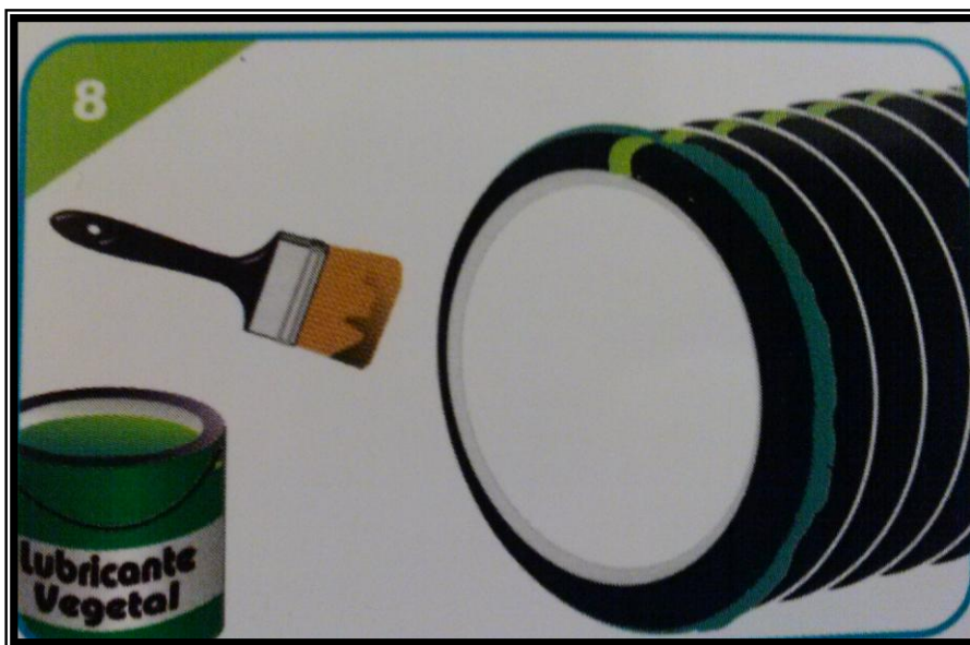
Figura 3.6.8 Lubricación de tubo PEAD
