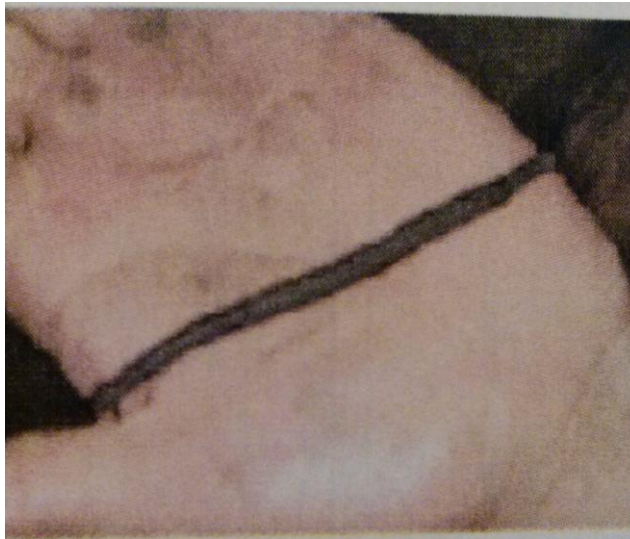
Figura 2.3.8 Formar un rollo de aproximadamente 3 mm de diámetro
