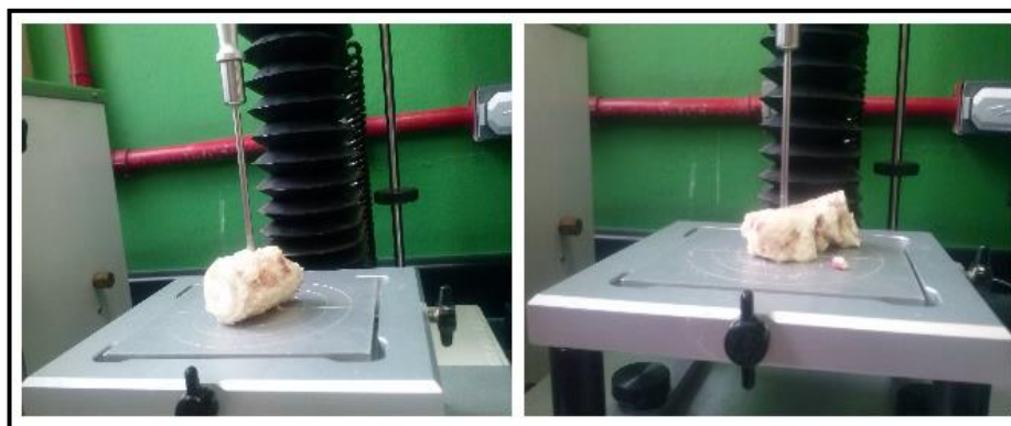
Figura 3.15 Determinación de dureza de espumas de albúmina de huevo con la goma en estudio
