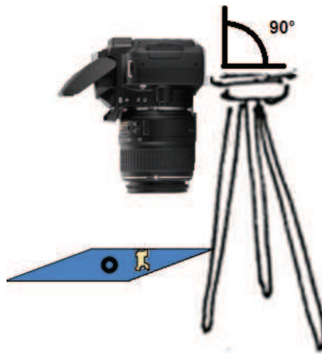
Figura 3.2. Diagrama representativo de la posición de la cámara.
