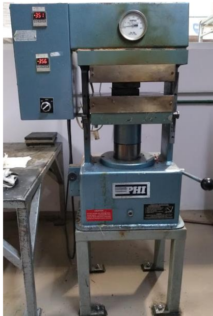
Figura 12. Moldeo por compresión con prensas hidráulicas marca PHI.
