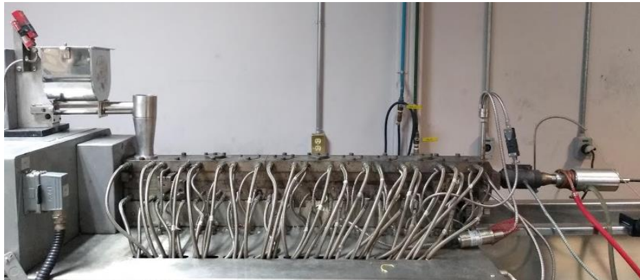
Figura 10. Extrusor de doble husillo asistido por ultrasonido de frecuencia variable.
