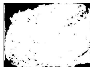
Figura A1- 14. Patrón de desplazamiento en la recuperación terciaria de petróleo con E-29 al 1% a una velocidad de 1.5 mL/min.
