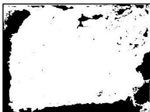
Figura A1- 18. Patrón de desplazamiento en la recuperación terciaria de petróleo con E-29 al 5% a una velocidad de 0.5 mL/min.
