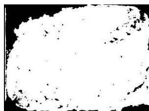
Figura A1- 14. Patrón de desplazamiento en la recuperación terciaria de petróleo con E-29 al 1% a una velocidad de 1.5 mL/min.
