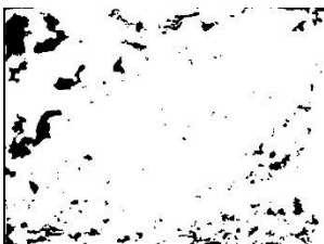
Figura A1- 20. Patrón de desplazamiento en la recuperación terciaria de petróleo con E-29 al 5% a una velocidad de 2.0 mL/min.
