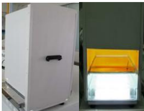
Figura 10. Celda Hele-Shaw saturada con petróleo.
