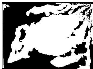
Figura A1- 10. Patrón de desplazamiento en la recuperación terciaria de petróleo con E-18 al 5% a una velocidad de 2.5 mL/min.
