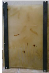
Figura 46. Modificación a la celda Hele-Shaw (uso de soleras).
