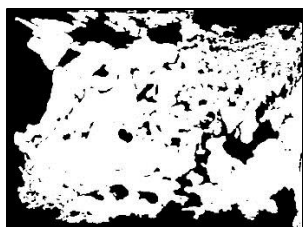
Figura AI- 1. Patrón de desplazamiento en la recuperación terciaria de petróleo con E-18 al 1% a una velocidad de 0.5 mL/min.
