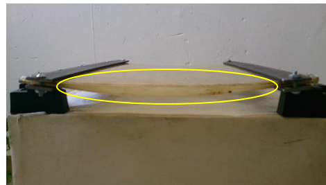
Figura 45. Celda de acrílico Hele-Shaw con arqueamiento en la zona central.
