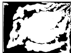
Figura A1- 10. Patrón de desplazamiento en la recuperación terciaria de petróleo con E-18 al 5% a una velocidad de 2.5 mL/min.
