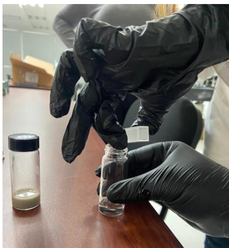
Figura 19. Llenando las celdas de cuarzo en la caracterización UV-Vis.
