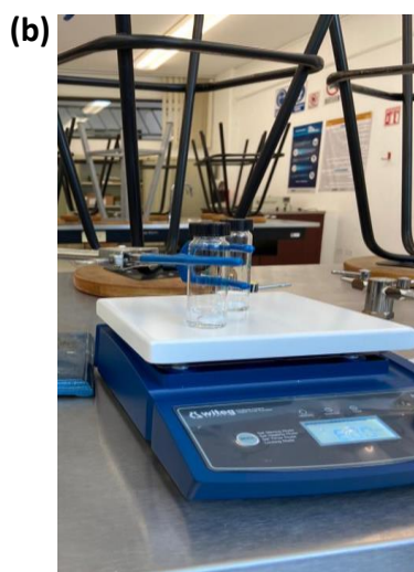
Figura 8. (a) Matraz de 3 bocas con PVP bajo agitación constante. (b) Viales con Nitrato de Plata y Cloruro de Sodio bajo agitación constante.
