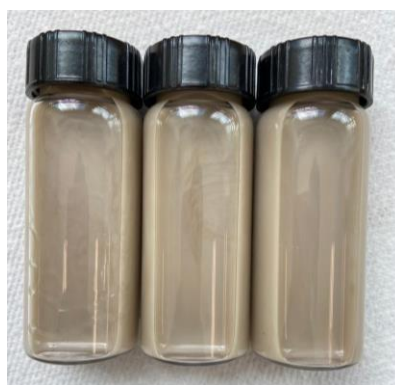
Figura 13. Viales con la solución de NAs de Ag sometida a 4 procesos de lavado.
