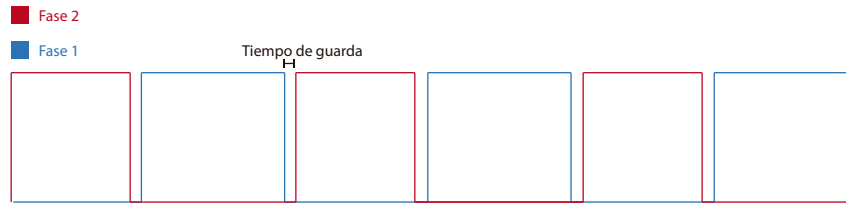
Figura 3.5: Fases de reloj sin solapamiento.
