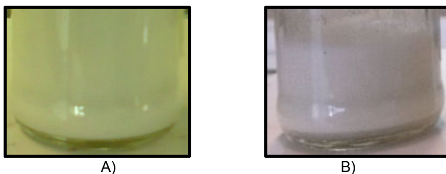
Fig 3.14. Emulsión M8 con BRIJ L23 al 2 % A) tras prepararse, B) 8 meses después.
