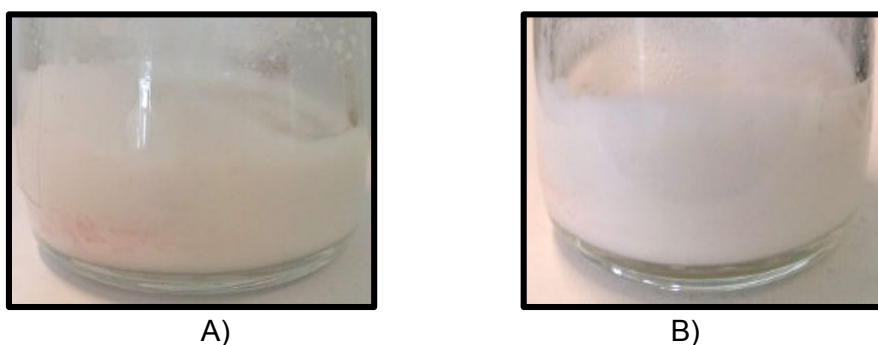
Fig 3.17. Emulsión T9 con BRIJ L23 al 2 % A) tras prepararse, B) 4 meses después.
