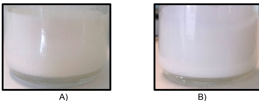
Fig 3.20. Emulsión C9 con BRIJ L23 al 2 % A) tras prepararse, B) 6 meses después.
