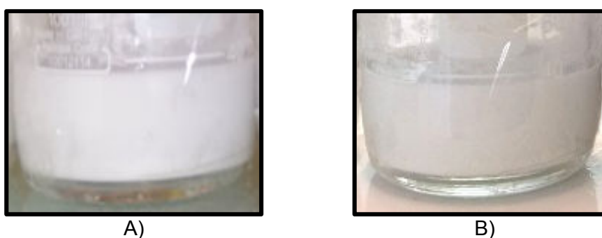
Fig 3.28. Emulsión E41 con IGEPAL CO-890 al 3 % A) tras prepararse, B) 5 meses después.
