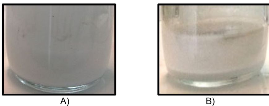
Fig 3.21. Emulsión E27 con TERGITOL NP-40 al 1 % A) tras prepararse, B) 27 días después.
