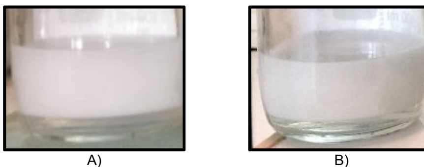
Fig 3.27. Emulsión E38 con TERGITOL NP-40 al 1 % A) tras prepararse, B) 3 meses después.
