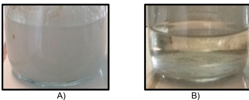
Fig 3.22. Emulsión E28 con BRIJ L23 al 2 % A) tras prepararse, B) 3 días después.
