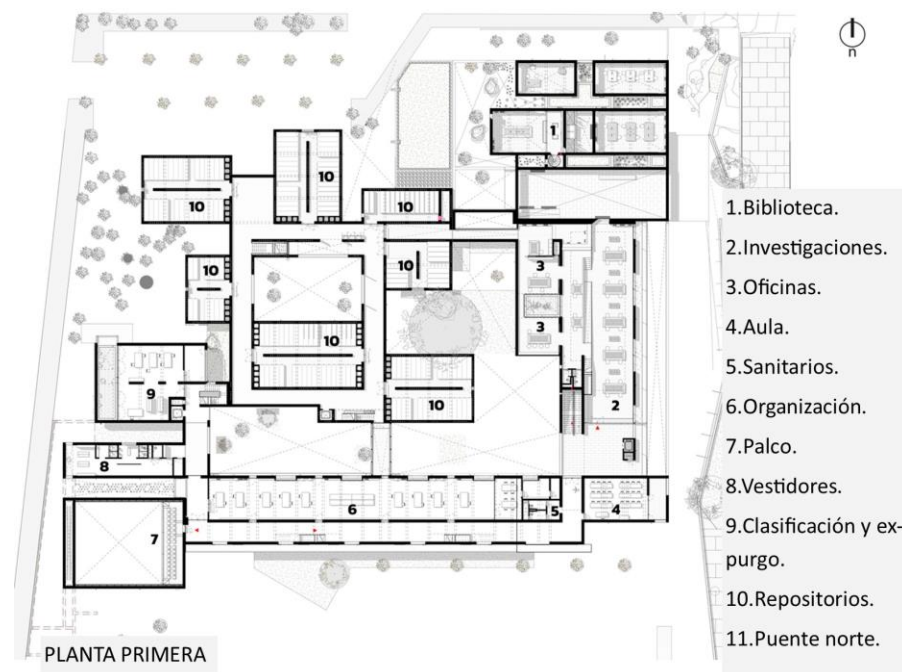
Figura 24. Planta primera del Edificio del Archivo Histórico del Estado de Oaxaca. Fuente: Imagen recuperada de https://www.archdaily.mx/mx/868853/edificio-del-archivo-historico-del-estado-de-oaxaca-mendaro-arquitectos (2021).
