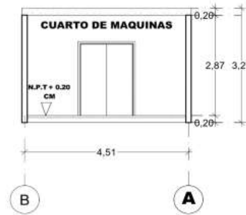
CORTE TRANSVERSAL CUARTO DE MAQUINAS ESC: 1:50
