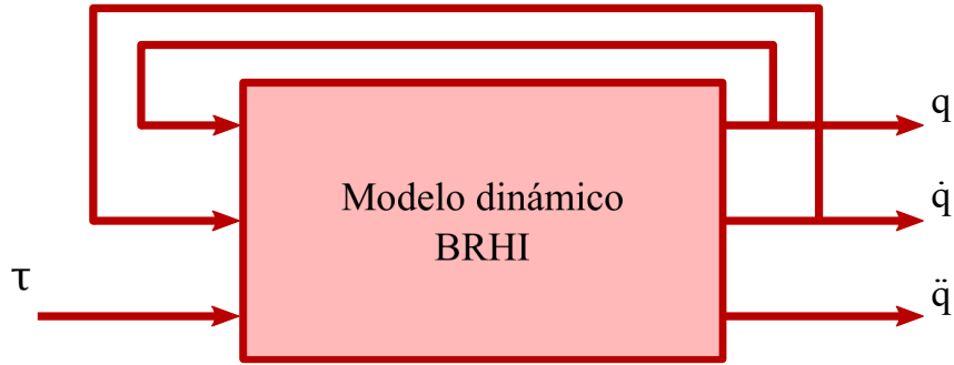
Figura 2.8: Representación entrada-salida del modelo dinámico del BRHI.
