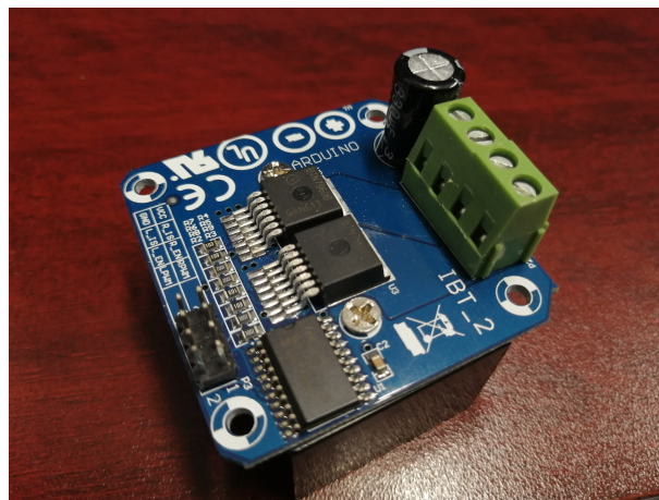
Figura 4.2: Modulo controlador puente H IBT_2.
