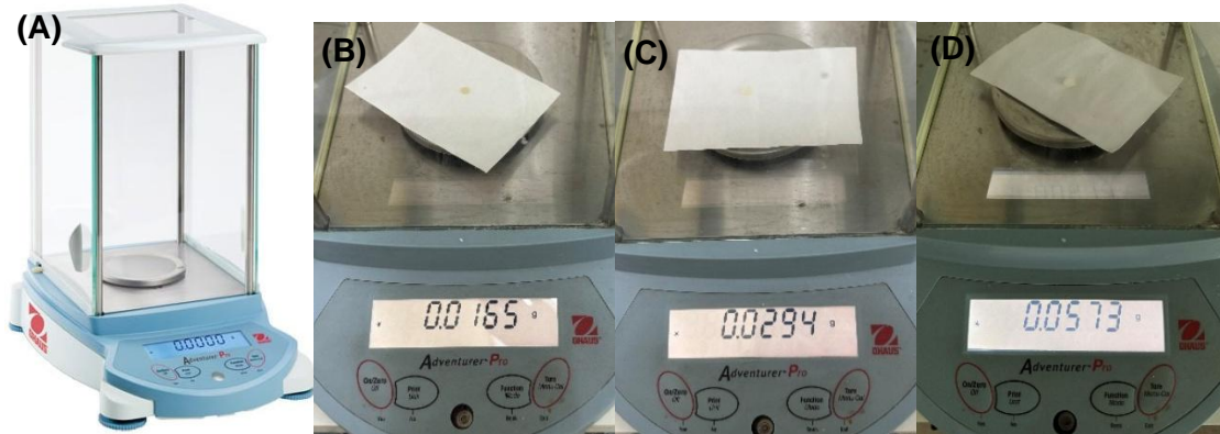
Figura 16. (A) Balanza analítica Ohaus AV114 Adventurer Pro (Ohaus Corporation, Parsippany, NJ, USA). (B) Ejemplo del procedimiento de pesaje inicial de una película antes de ser inmersa en saliva artificial. (C) Pesaje a los 5 minutos de ser inmersa en saliva. (D) Pesaje 1 hora después de ser inmersa en saliva. Fuente propia.
