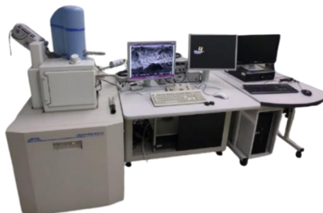
Figura 12. SEM JSM-5800LV (JEOL Ltd., Akishima, Tokyo, Japón). Fuente propia.
