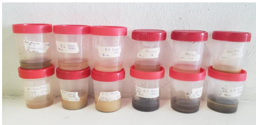
Imagen 17. Extractos de saturación de las diferentes muestras de la primera toma. Fuente: Propia
