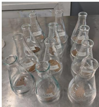
Imagen 20. Preparación de la muestra para determinación de calcio. Fuente: Propia
