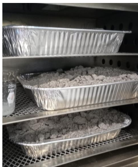
Imagen 12. Secado de muestras en estufa a 105 °C. Fuente: Propia
