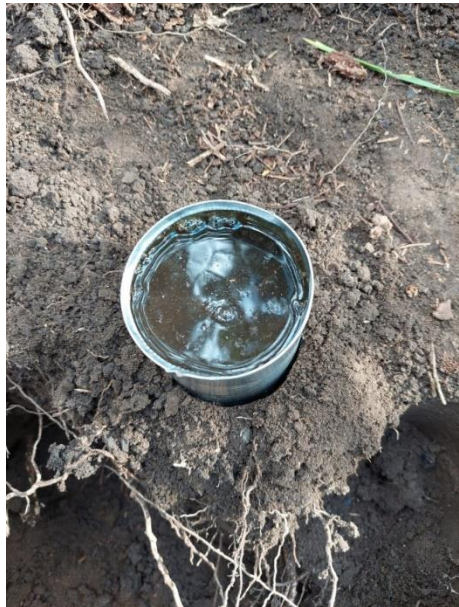
Imagen 8. Toma de muestra y prueba de infiltración en campo, de zona conservada alta Fuente: Propia
