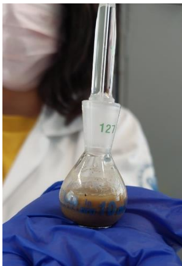
Imagen 11. Pícnometro con muestra y agua. Fuente: Propia
