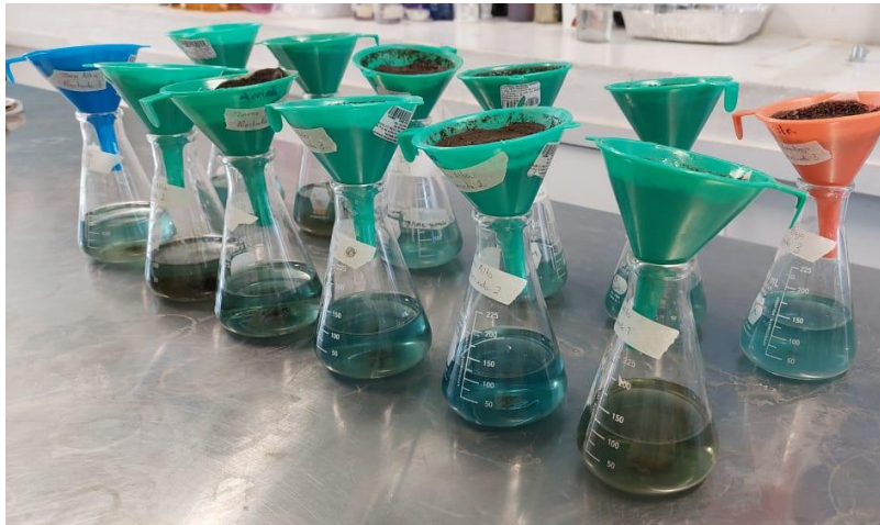
Imagen 24. Determinación de capacidad de intercambio catiónico. Fuente: Propia
