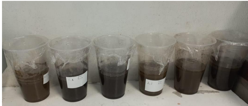
Imagen 10. Pasta saturada de diferentes muestras. Fuente: Propia
