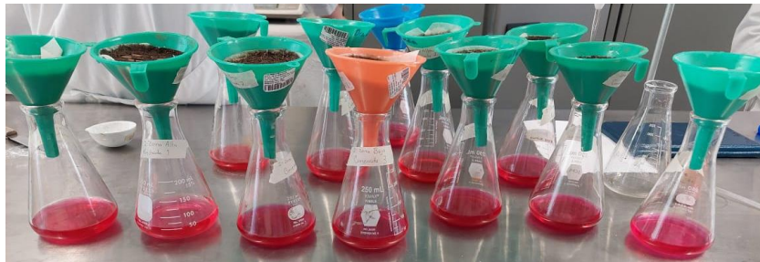
Imagen 23. Determinación de acidez extraíble. Fuente: Propia
