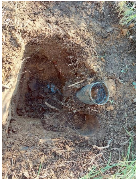
Imagen 9. Toma de muestra y prueba de infiltración en campo, de zona afectada baja Fuente: Propia
