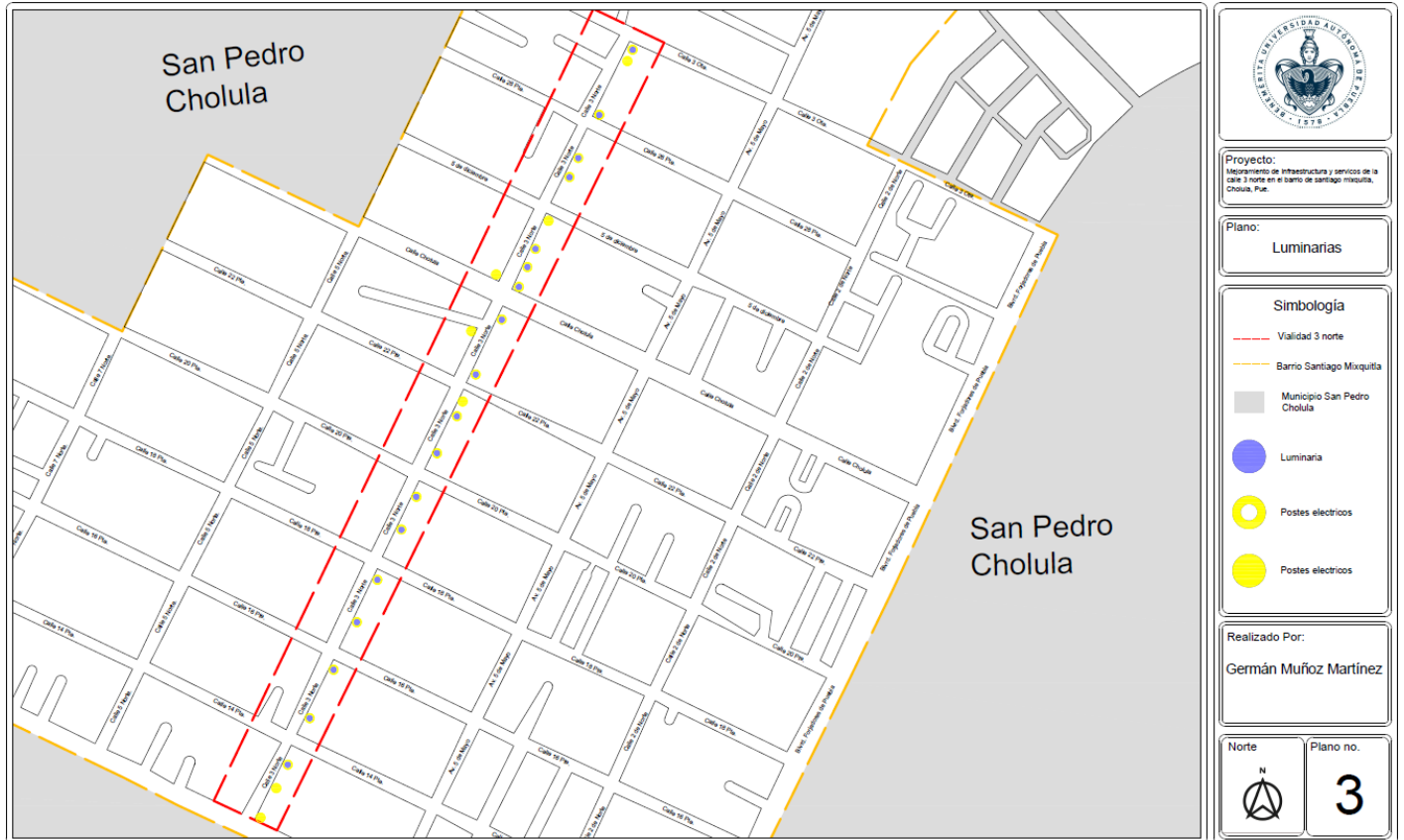
Fig. 13; plano de luminarias existentes en la actualidad.
