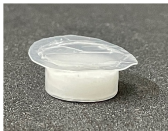
Figura 28. Pastilla del adamantano encapsulada con polietileno.
