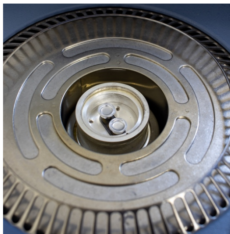
Figura 22. Disposición de las celdas en un experimento por DSC.
