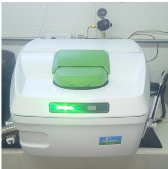
Figura 6. Especificaciones del calorímetro DSC8000 Perkin-Elmer.
