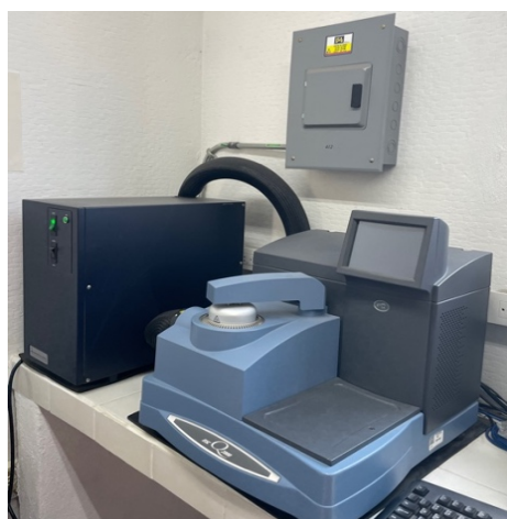
Figura 5. Especificaciones del calorímetro DSC Q2000 TA Instruments.
