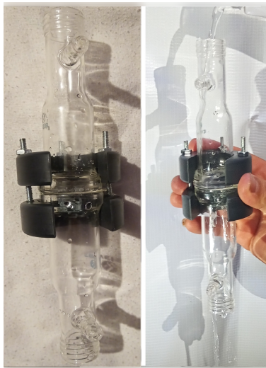
Figura 2.3: Dispositivo de filtración.
