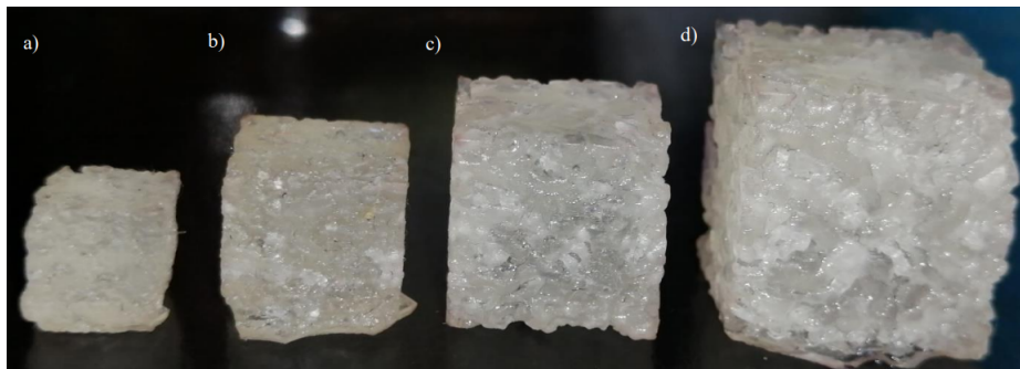
Figura 3.40: Impresiones de patrón isotrópico de morfología de tripas a escalas de a) 6.25 %, b) 7.8 %, c) 9.3 % y d) 12.5 % del tamaño original del patrón.
