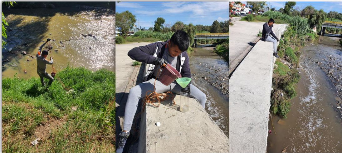
Figura 14. Toma de muestra de agua residual del punto de muestreo para los períodos correspondientes.
