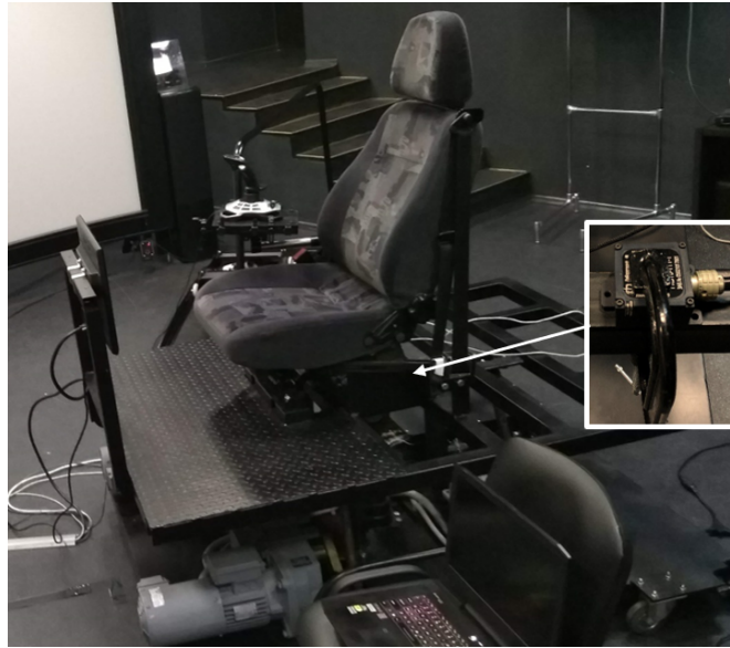
Figura 3.29: Instalaciones técnicas de la plataforma de 3 grados de libertad para los experimentos.
