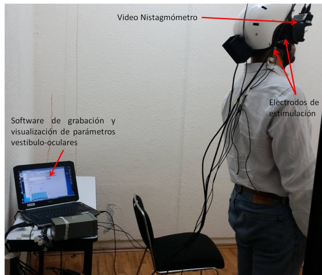
Figura 1.17: Configuración de pruebas de habituación con estimulación galvánica. La aplicación de estimulación se realiza manualmente inyectando corriente de diversas formas y amplitudes. Las respuestas de los ojos son medidas con cámaras oculares que detectan movimientos de la pupila. Dicha información es concentrada y procesada por el software de análisis de datos de la cámara.
