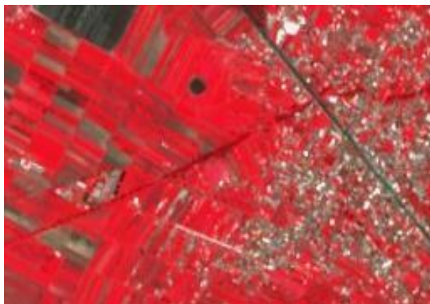
Figura 7. Combinación de color natural e Infrarrojo falso color, R = Banda 8, G = Banda 4, B = Banda 3. 25 de julio de 2021.
