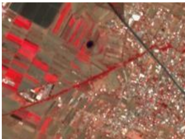
Figura 13. Combinación de color natural e Infrarrojo falso color, R = Banda 8, G = Banda 4, B = Banda 3. 25 de mayo de 2024.
