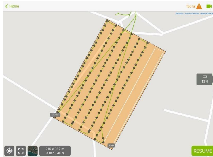
Figura 18. Trazo de vuelo fotogramétrico.
