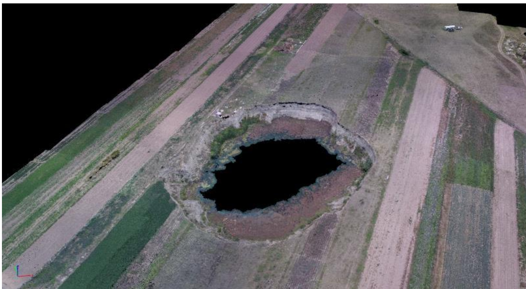
Figura 24. Imagen del socavón obtenida mediante el vuelo de dron y procesamiento en pix4dcapture.
