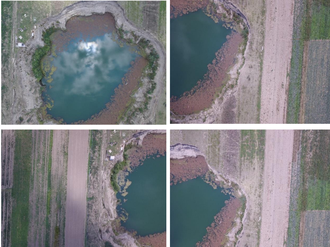
Figura 33. Fotografías del “socavón” obtenidas por un vuelo de dron, en ellas se puede observar a mayor detalle los derrumbes, sedimentos y profundidad que presenta el colapso.
