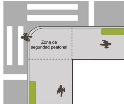
Figura 29. Zona de seguridad peatonal Fuente: Norma Técnica
