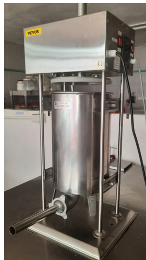
Figura 4.4. Embutidora eléctrica modelo Vevor usada para la elaboración de piezas individuales de salchicha.
