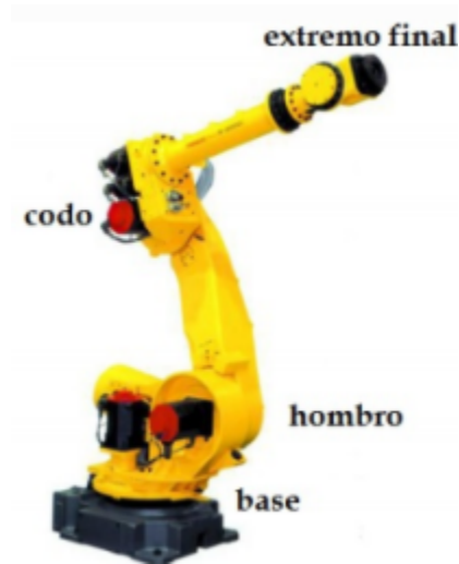
Figura 2.3: Extremo final en un robot FANUC [2]
