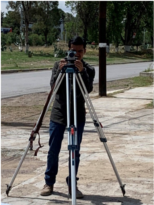
Figura 37, uso de nivel topográfico
