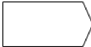
Figura 3.24: Elemento de un diagrama que representa una función externa que se ejecuta.
