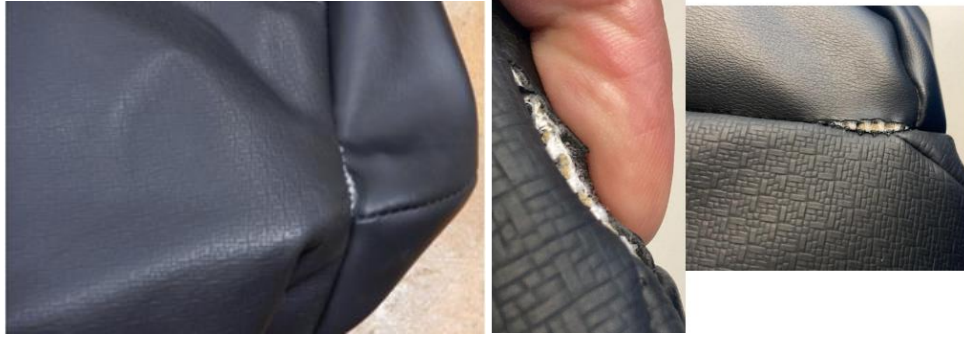
Figura 4 Representación de falla "Material Crack"
