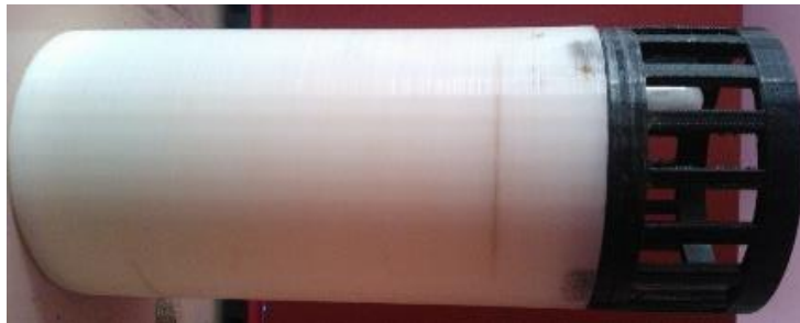
Figura 3.35 Primer diseño del bolo a introducir en la vaca.
