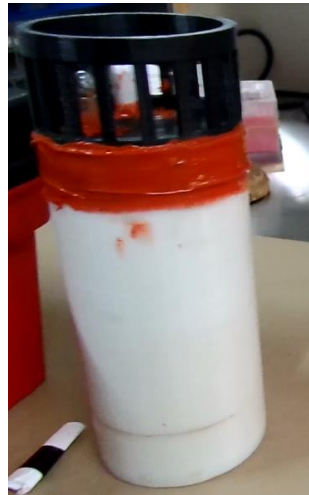
Figura 5.5 Bolo sellado con silicón rojo.
