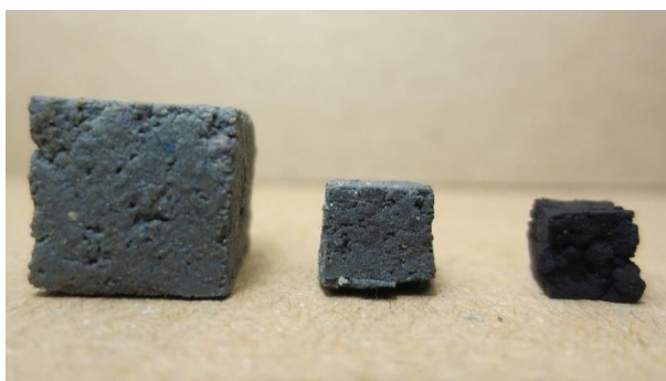
Figura 3.1 Aspecto de los materiales, de izquierda a derecha: lodo desmoldado, bricket seco y carbón activado
