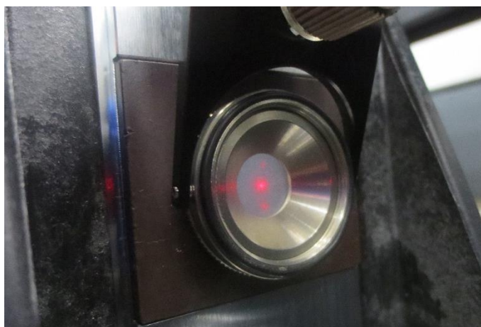
Figura 2.3 Disposición de la pastilla en el espectrofotómetro IR.
