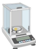
Figura 10. Balanza analítica utilizada para registrar el peso inicial y final de las muestras antes y después de la inmersión en la solución.
