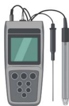
Figura 7. Analizador de iones 4 Star equipado con electrodo específico para iones de fluoruro.
