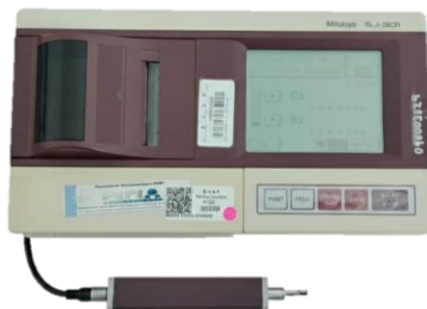
Figura 6. Perfilómetro Mitutoyo (Surftest SJ-210, Tokyo, Japón) utilizado para evaluar rugosidad superficial.
