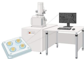
Figura 5. Microscopio Electrónico de Barrido (MEB) (JEOL, JSM-6610LV) utilizado para evaluar la caracterización de los materiales.
