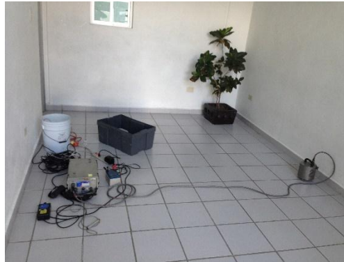
Figura 3.18 Medición de ruido ambiental en segundo nivel de edificio ING7
