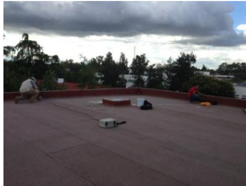
Figura 3.15 Medición de ruido ambiental en losa de azotea de edificio ING7
