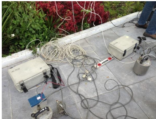
Figura 2.4 Imagen de Equipo K2 conectado a un equipo Guralp cada uno.
