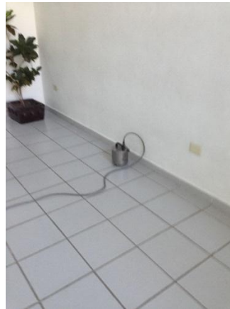
Figura 3.19 Medición de ruido ambiental en segundo nivel de edificio ING7
